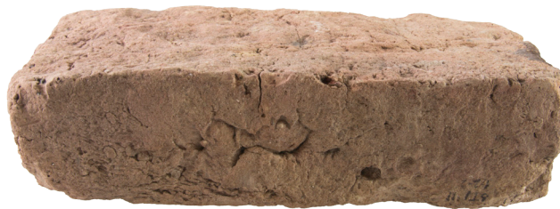
Afb. 9. Baksteen met afmeting van 31.5x15x7.5 cm. Schaal 1:3.
